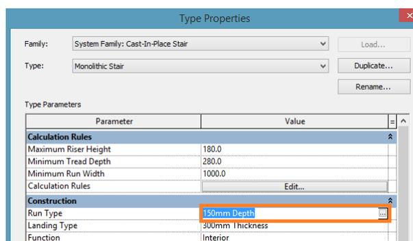
Seguidamente, ter-se-á a possibilidade de escolher o tipo de **Run Type** pretendido, dentro das profundidades de cobertor que a tipologia **DG** da série CROMÁTICA permite:
