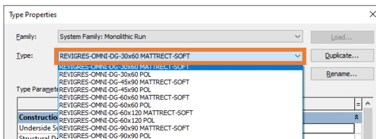
Após escolhido o tipo de objeto da tipologia **DG**, deverá ser escolhido o material a aplicar à peça DG, na secção **Materials and Finishes** no parâmetro **Tread Material**:
