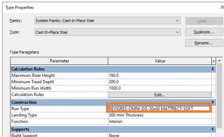
Seguidamente, ter-se-á a possibilidade de escolher o tipo de **Run Type** pretendido, dentro das profundidades de cobertor que a tipologia **DG** da série NORDIK permite:
